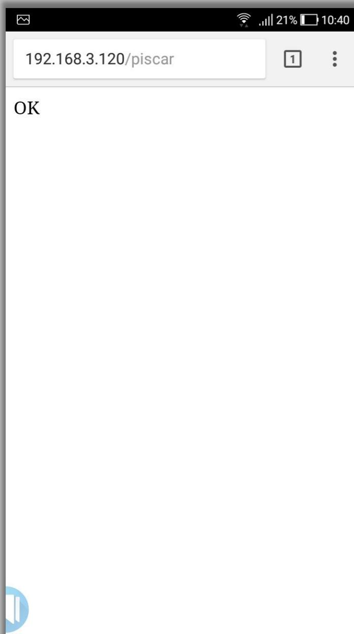
Para verificar se o seu celular **pode se comunicar com o ESP32**, abra o navegador e digite conforme a figura, lembrando que o **ip** deve ser o **mesmo** definido em **"staticIP792"** no código ino do ESP32.
