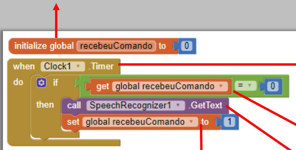
Este loop é executado assim que o aplicativo é aberto e ele funciona de tempo tempo (milissegundos). É como se fosse o loop do Arduino IDE, só que de acordo com o clock deste componente.
